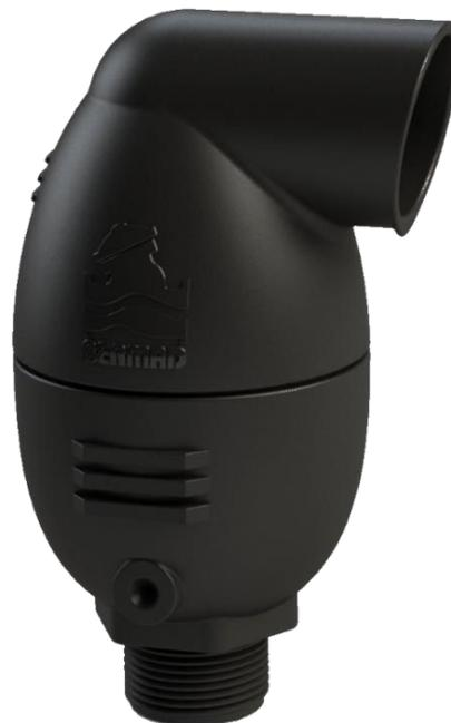
A Válvula Ventosa Bermad modelo C30 é de tríplice função e apresenta alta performance para os mais variados sistemas hidráulicos e condições operacionais. Ela possibilita a expulsão do ar com altas vazões durante o enchimento da rede, libera bolhas de ar que se formam com a rede em operação e admite a entrada de ar com altas vazões, no caso de drenagem.
