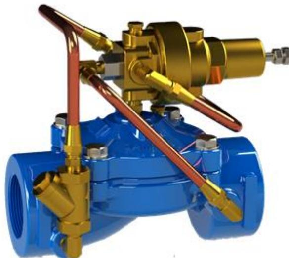
A válvula de alívio e segurança mod. 430 é instalada em derivação da rede que protege e foi projetada para remover volumes excessivos de água, protegendo sistemas hidráulicos ou equipamentos contra sobre pressões e prevenindo rupturas.
