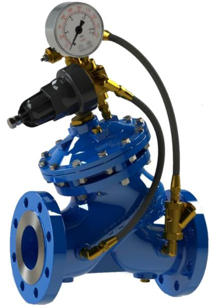
As Válvulas Redutoras de Pressão modelo 720 são dispositivos que, instalados nas redes de distribuição de água, reduzem a pressão de entrada a uma pressão de saída estável e constante, independentemente das variações normais de vazão e pressão do sistema. O piloto redutor monitora a pressão a jusante e modula a abertura da válvula, mantendo a pressão de saída no valor pré-estabelecido. Quando não há consumo, a válvula se fecha automaticamente.
