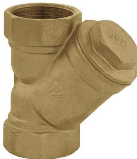
Para evitar a interferência no desempenho das válvulas redutoras de pressão, recomenda-se que a malha do elemento filtrante seja de, no mínimo 500 micron e 35 mesh. Para facilitar a limpeza, o filtro Y deve ser instalado com a tampa preferencialmente voltada para baixo. Não é recomendável a sua instalação em barriletes, em virtude das altas perdas de carga envolvidas.
